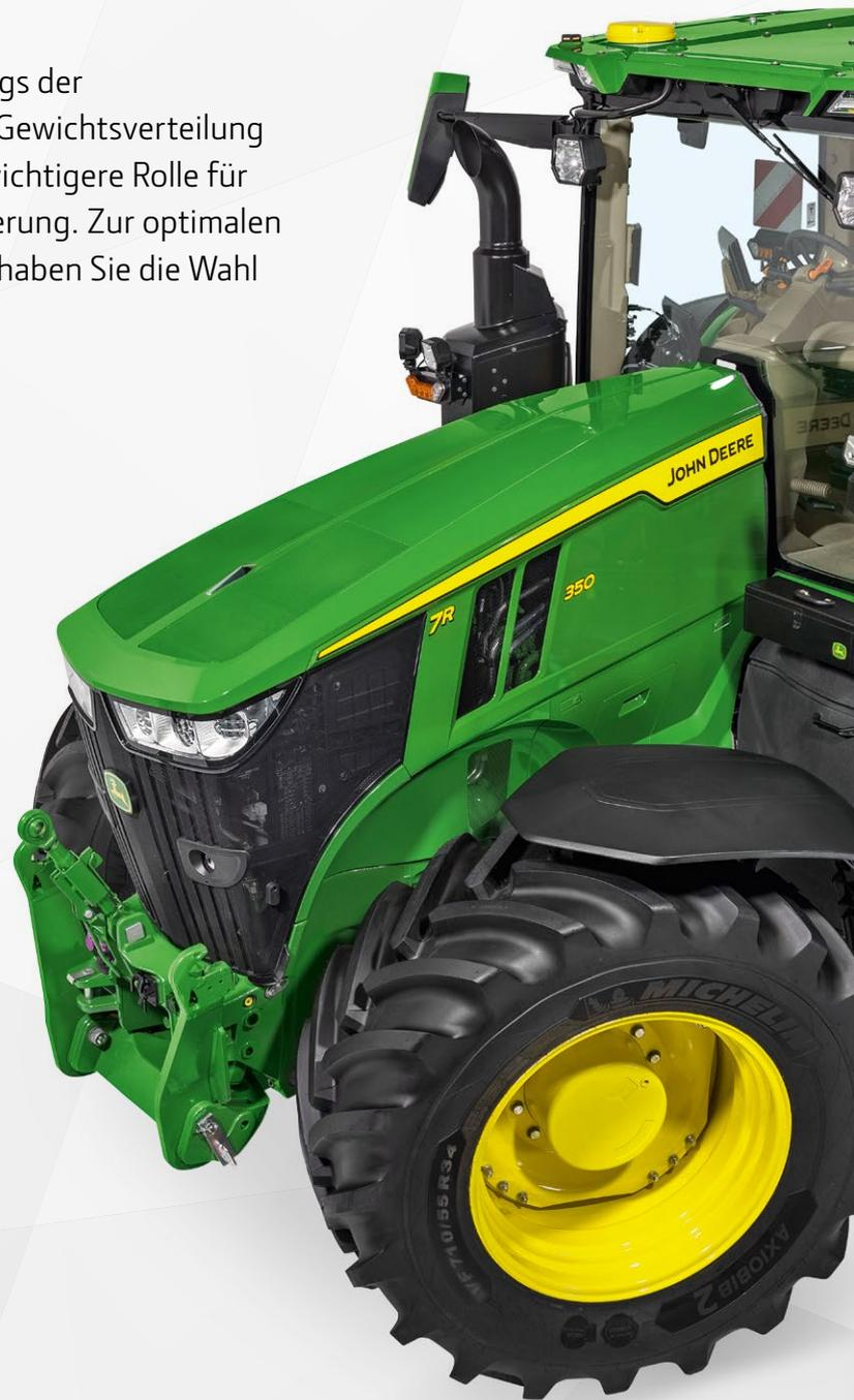
Pickup-Gewichte sind in den Ausführungen 900 kg, 1.150 kg, 1.500 kg und 1.800 kg erhältlich. Bis zu 22 Front-Koffergewichte mit einem Gewicht von je 50 kg.
