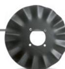
Schlitzscheibe mit Wellenprofil\* (13 Wellen - 18 mm) bearbeitet einen Bereich von etwa 25 mm Breite bei Geschwindigkeiten von bis zu 10 km/h.
