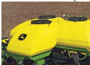
Kapazitätssteigerung – Diese Option fügt einen dritten Behälter mit 880 Liter Kapazität vor den zwei Standard CCS-Saatgutbehältern hinzu, für ein Fassungsvermögen von bis zu 4400 Liter Saatgut.
