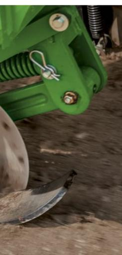
An der Reiheneinheit montierter Einscheiben-Furchenzieher – Weniger Bodenbewegungen, ideal für konventionelle und reduzierte Bodenbearbeitungs-, und Direktsaat-Verfahren.
