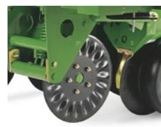
Extra stark – Diese rahnenmontierten Hochleistungs-Schlitz-scheiben\* mit Spezialprofil eignen sich hervorragend zur Aussaat in steinigem Bodenverhältnissen.
