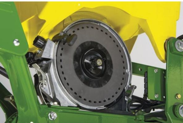
ProMAX 40 Flachscheibe – Präzise Vereinzeln von Maiskörnern unterschiedlicher Größe oder Form mit der John Deere ProMAX 40 Flachscheibe, die für das John Deere VacuMeter-Dosiersystem entwickelt wurde.
