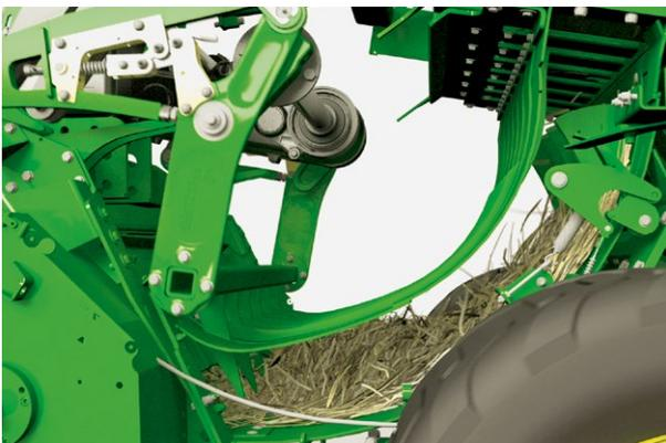
1 | Die Zuführgabel befördert das Erntegut hinter dem Rotor in den Vorpresskanal, wo es zu einheitlichen, vorgepressten Ballenlagen vorverdichtet wird.
