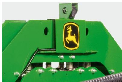
Am Heck montierte Ballenablagekamera – mit integriertem Schutz, montierbar in zwei Positionen, damit Sie auf dem Zusatzmonitor die Ballenablage verfolgen können.
