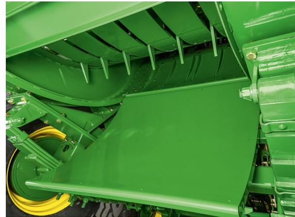
Durch den einfachen Wartungszugang der weit öffnenden Bodenklappe des Rafferbodens können Sie eine Verstopfung im Vorpresskanal schneller und einfacher beseitigen.
