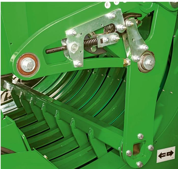
Vorverdichtete Ballenlagen einheitlicher Größe sind die Grundvoraussetzung für perfekt geformte und dichte Ballen. Deshalb arbeitet die Zuführgabel in zwei verschiedenen Modi: „Automatikmodus“ zur Aufnahme von ungleichmäßig großen Schwaden und „kontinuierlicher Modus“ für große, gleichmäßige Schwade. Das verstärkte, wartungsarme Presssystem der L600, das für verschiedene Erntegutarten geeignet ist, formt jeden Ballen erst dann, wenn die Presskammer komplett voll ist.
