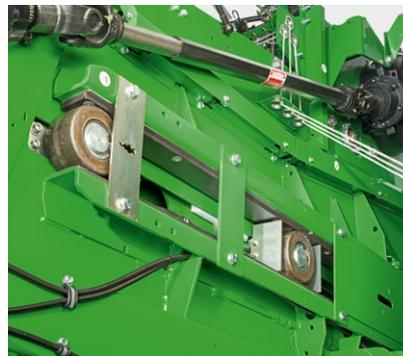
Immer perfekt abgestimmt – bei der aktualisierten Kraftübertragung werden die Knoter direkt über Getriebe und Wellen angetrieben.
