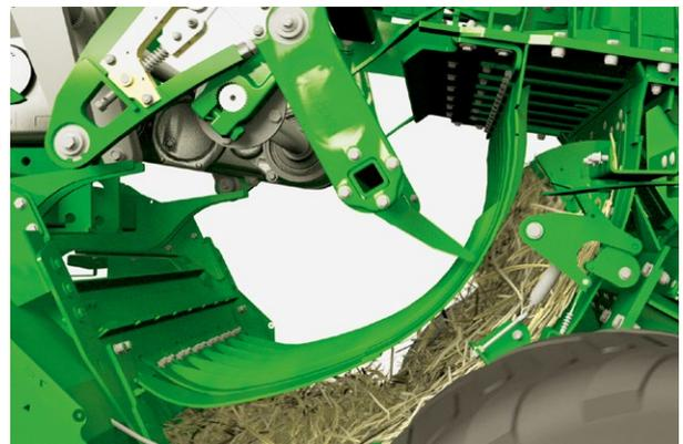
2 | Sobald die Kammer gefüllt ist, löst der Druck automatisch einen Förderhub des Raffers aus.
