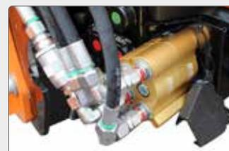
Die Fronthydraulik kann mit einem 4-fach **Multikuppler** ausgerüstet werden. Der Gerätewechsel ist somit noch schneller und einfacher möglich.
