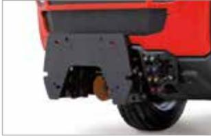
Mit der **Geräteanbauplatte** können Frontgeräte auch direkt angebaut werden z.B. Schneepflug oder -fräse.
