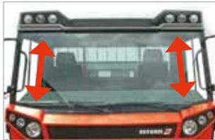
Im Dach des Muli T10 X lassen sich pro Seite bis zu 3 Arbeitscheinwerfer oder eine **Wechselbeleuchtung** für den Einsatz mit Frontanbaugerät montieren.
