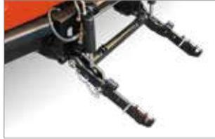
Das **Front-3-Punkt-Hubwerk** mit Gabeln ist mit elektrohydr. Geräteentlastung sowie Schwingungsdämpfung erhältlich.
