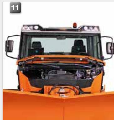
Die **serienmäßige Kippkabine (10)** des Muli T10 X ermöglicht es für Wartungs- und Reparaturarbeiten rasch an den Motorraum zu gelangen. Die werkzeuglos, hydraulisch zur Seite kippbare Kabine lässt sich in kürzester Zeit anheben. Durch das seitliche Kippen müssen Frontanbaugeräte wie ein Mähwerk oder ein Schneepflug nicht demontiert werden.
