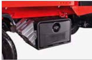
Die spritzwasserdichte und abschließbare **Werkzeugkiste** aus Polyethylen bietet genügend Stauraum für Zurrgurte, Werkzeuge oder Zubehör.
