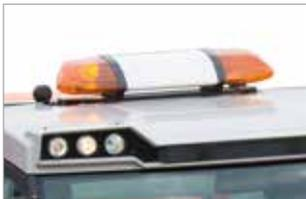
Das **optische Warnsystem** lässt sich auf dem Dach des Muli montieren und kann individuell beschriftet werden.
