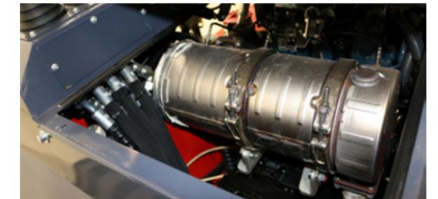
EURO 5 Emissionsklassifizierung - alle unsere Dieselantriebe mit mehr als 26PS sind mit Partikelfilter ausgestattet.
