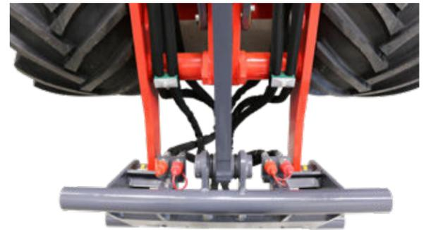
SMS-Schellwechselsystem und hydraulische Werkzeugverriegelung serienmäßig. Die 3. Funktion ist Standard, die 4. ist optional erhältlich.
