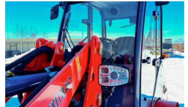
Der 1350 besitzt LED-Fahrlicht und LED-Arbeitsbeleuchtung bereits in der Grundausstattung. In der Kabine finden sich Radio und Lautsprecher.
