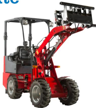
LRF – Schraubdach, klappbarer Überrollbügel.
