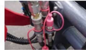
Freier Hydraulikrücklauf an der Vorderseite des Laders.
