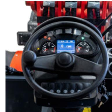
Übersichtliche Instrumente mit einem ergonomischen, leicht zu manövrierenden Joystick für den Lader mit integrierter Vorwärts- und Rückwärtsfahrsteuerung. Die Geschwindigkeit ist stufenlos über ein Fußpedal mit Kriechgang-Funktion einstellbar.
