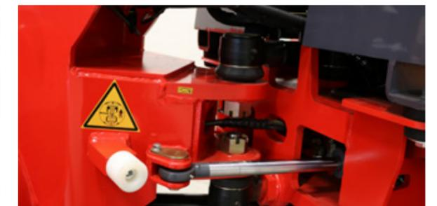
Robuste, schwenkbare Gelenkverbindung mit begrenzter Drehmöglichkeit für maximale Traktion und Nachgiebigkeit, bei gleichzeitig hoher Stabilität beim Laden.
