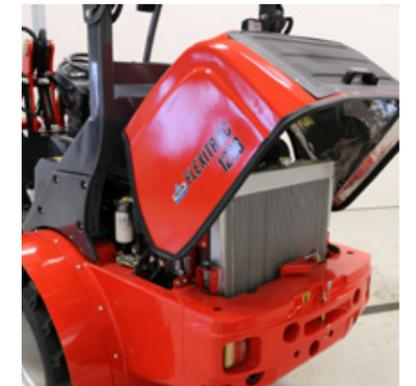
Die aufklappbare Motorhaube bietet guten Zugriff für Wartung und Service. Großzügiges Kühlsystem für Hydraulik und Motor.
