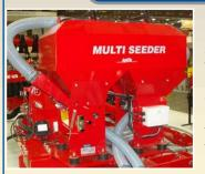
Multi-Seeder Twin ist ein Behälter mit zwei Einheiten sowie zwei Dosiereinheiten, was ermöglicht, die Saatmenge unabhänigig von einandern einzustellen. Multi-Seeder Twin ist damit für Säen von Raps ideal, wo auch Schneckengift platziert werden soll.
