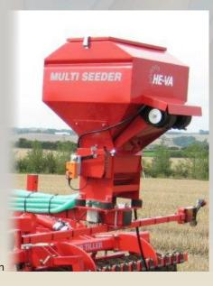
Die Saatmenge erfolgt via 5-24 speziell angefertigte Verteilerteller, die individuell an den einzelnen Geräten plaziert werden können. HE-VA bietet im Werk montierte oder angepaßte Montagesätze für Multi-Seeder für die meisten HE-VA Geräte an.
