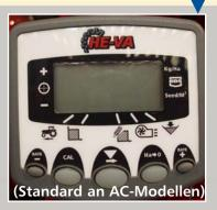
Durch das Montieren des Auto-Controllers läßt sich die Saatmenge durch die Box während der Fahrt stufenlos einstellen. Die Abdrehprobe der Maschine ist dadurch ausgeführt, daß die Dosiereinheit durch einen Schalter an der Multi-Seeder aktiviert wird. Der Auto-Controller hat Überwachung und Alarm an Gebläse, an Behälterniveau sowie Prestart-Funktion für das Aussäen in Ackerecken u.ä. Ein Oberlenkerschalter für Start und Stopp vom Aussäen ist mitgeliefert.
