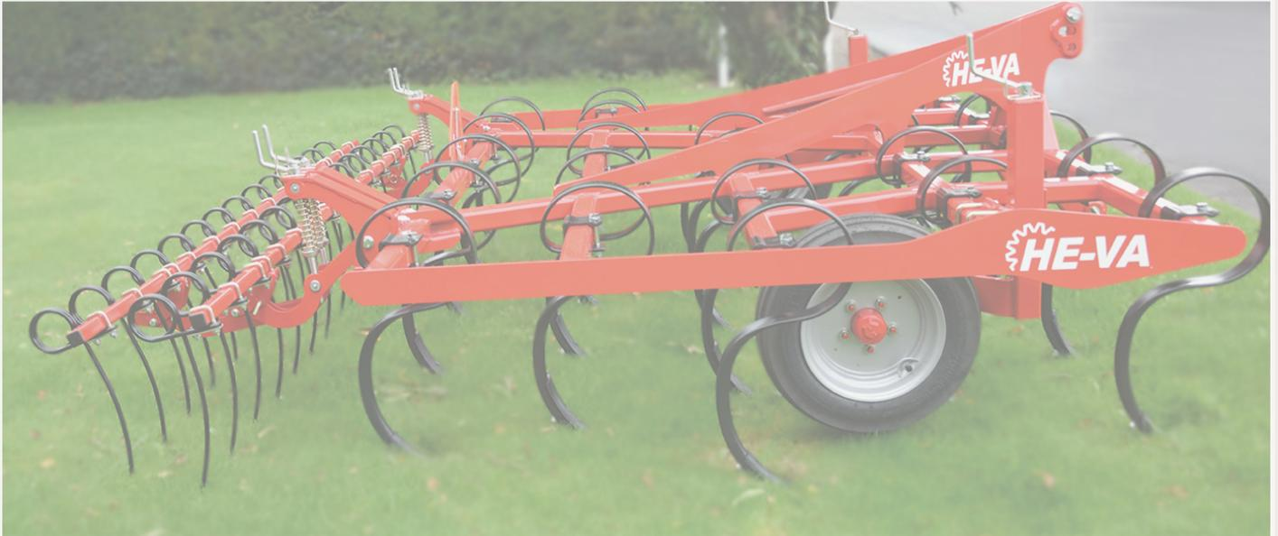
Die schweren 70x12mm können wahlweise mit Wende- oder Gänsefußscharen ausgerüstet werden, um allen Anwendungsszenarien gerecht zu werden. Selbst eine Kombination beider Schar Typen ist möglich.
