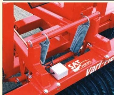
Durch das SAT-System an HE-VA Swing-Roller ist ein gleichmäßiges Gewicht auf allen 5 Segmenten gewährleistet.
