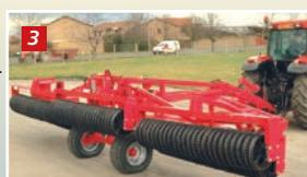
3 Der Zylinder des Fahrgestells wird automatisch aktiviert - die Räder vorwärts drehen und aufheben (1. Anschluß)
