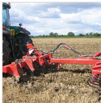
Combi-Tiller MKI m/Dreipunktaufnahme u. Zugmaul f/Kombination m/aufgehängten und aufgesattelten Geräten wie z.B. "Dammformer" f/Kartoffeln oder aufgesattelte Drillmaschinen.
