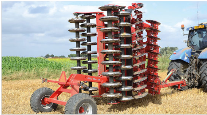
5,50 m Disc-Roller Contour mit Twin V-Profilwalze und Spritztuch für das Material.
