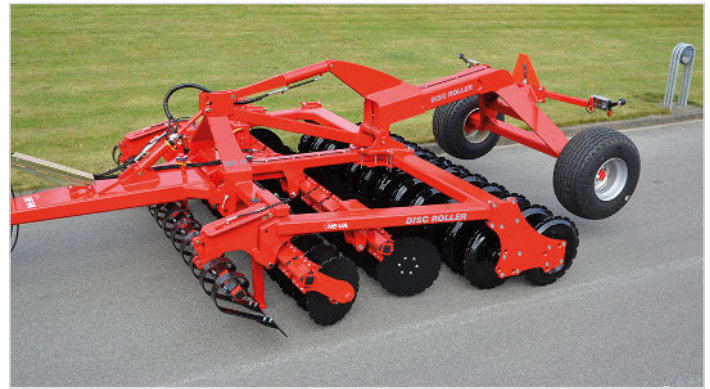
3,50 m Disc-Roller Contour aufgesattelt m/Twin V-Profilwalze und Spring-Board
