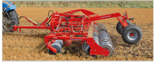
5,50 m mit Twin V-Profilwalze und Spritz Tuch für das Material
