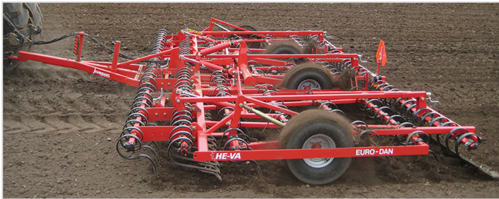
Euro-Dan Eco 8,00 m mit robuster Frontegge, Spring-Board-Schiene mit Schleppzinken und Spring-Board-Striegel.
