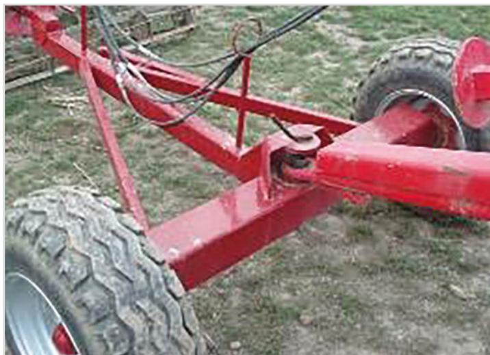
Dolly: Radsatz, der eine Ankupplung von Walzen hinter der Egge ermöglicht – 11.5/80 x 15.3 Rad.
