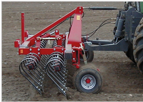
4,00 m Front-Board mit Krustenbrecherscharen.
