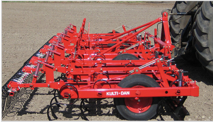
6,40 m Kulti-Dan mit Planierschiene und Striegel
