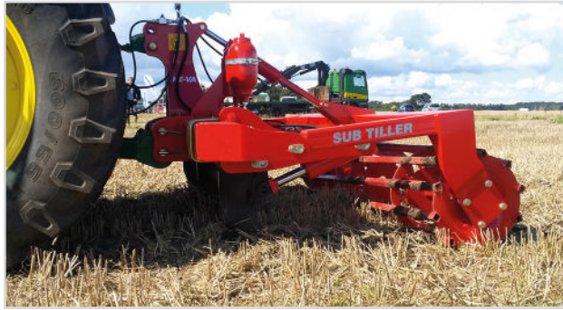
3,00 m m/hydr. Steinsicherung, 4 Zinken, schwerer Rohrwalze und hydr. Tiefenregelung.
