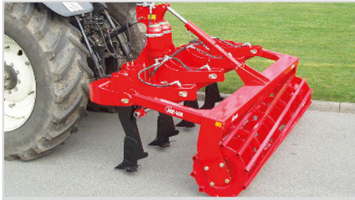
3,00 m m/hydr. Steinsicherung, 4 Zinken, schwerer Rohrwalze und hydr. Tiefenregelung.
