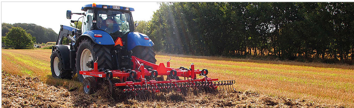
4,00 m Triple-Tiller Airy mit Federzinken
