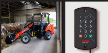
**Maschinenschutz durch Zugangsberechtigung per Code!**
