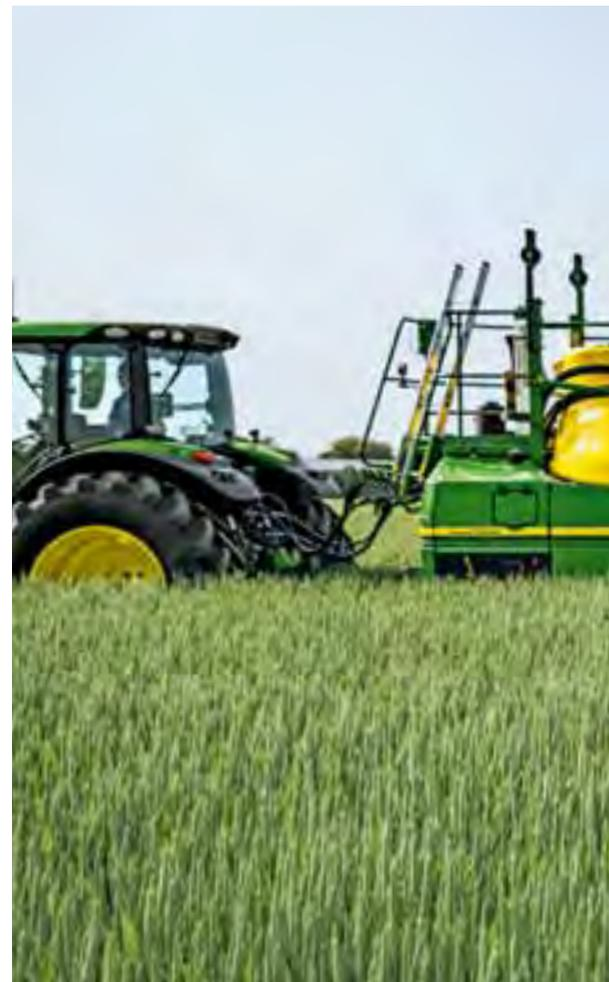
Bei TerrainCommand Pro helfen drei bis fünf Ultraschallsensoren mit IMU dabei, das Spritzgestänge jederzeit richtig zu positionieren – und sorgen so für konstante Spritzgestängehöhen für perfekte Ausbringungsabdeckung, weniger Abdrift, höhere Geschwindigkeiten und weniger Stress für den Fahrer.
