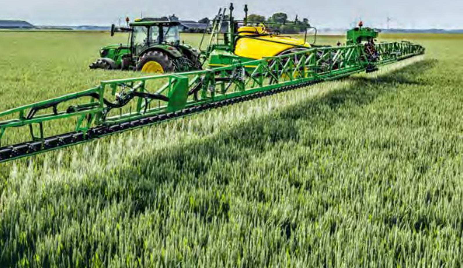
PowrSpray™: Die direkte Mengensteuerung reagiert blitzschnell auf Geschwindigkeitsänderungen oder Teilbreitenwechsel, um eine Über- und Unterdosierung zu verhindern. Bei teilflächenspezifischen Ausbringungsmengen erfolgt die Umstellung praktisch ohne Verzögerung.
