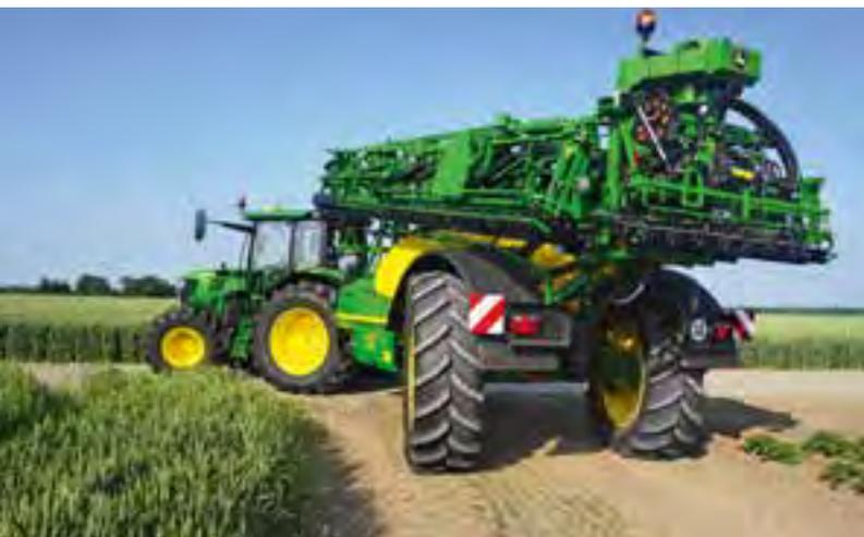
Bei sicher für den Transport befestigtem Spritzgestänge lässt sich diese Feldspritze mit Geschwindigkeiten von bis zu 40 km/h\* ziehen. Unsere wartungsfreie, gefederte Zweilenkerachse schluckt wirksam Stöße und schützt die Feldspritze zusätzlich – damit Sie viele Jahre Freude an Ihrer Maschine haben.
