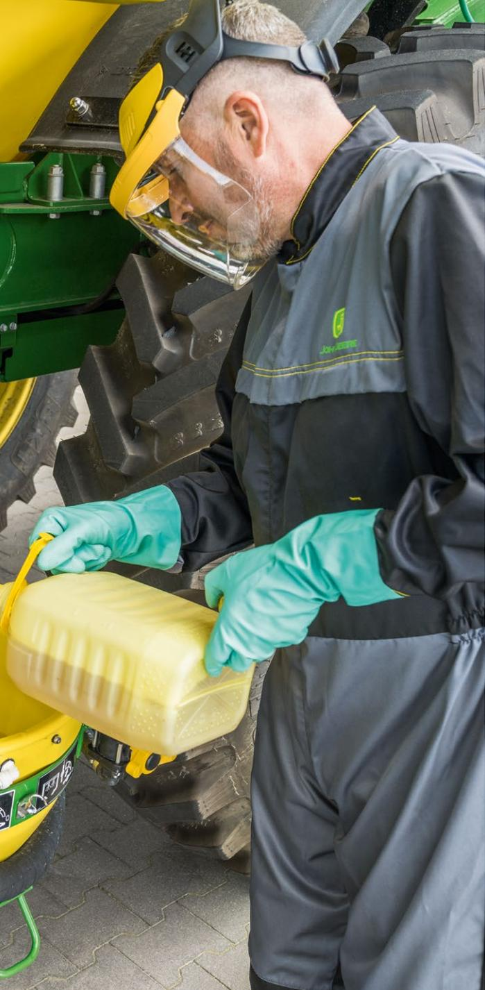
Die PowrFill Einspülschleuse ist schnell und einfach zu bedienen. Reinigungsdüsen verdünnen die Pflanzenschutz- sowie Düngemittel und sorgen für eine gründliche Reinigung der Einspülschleuse. Alle Produkte fließen durch den Filterkorb in der Tanköffnung, bevor sie den Brühbehälter erreichen. Dadurch wird verhindert, dass versehentlich angesaugte Verunreinigungen in den Tank gelangen (z. B. Dosendichtungen oder Blätter).
