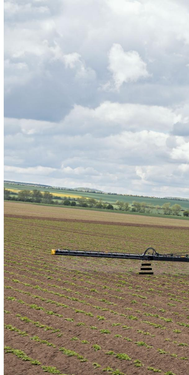
Zwei bis fünf Ultraschallsensoren mit IMU helfen dabei, das Spritzgestänge jederzeit richtig zu positionieren – und sorgen so für konstante Ausbringhöhen, weniger Abdrift, höhere Geschwindigkeiten und weniger Stress für den Fahrer.
