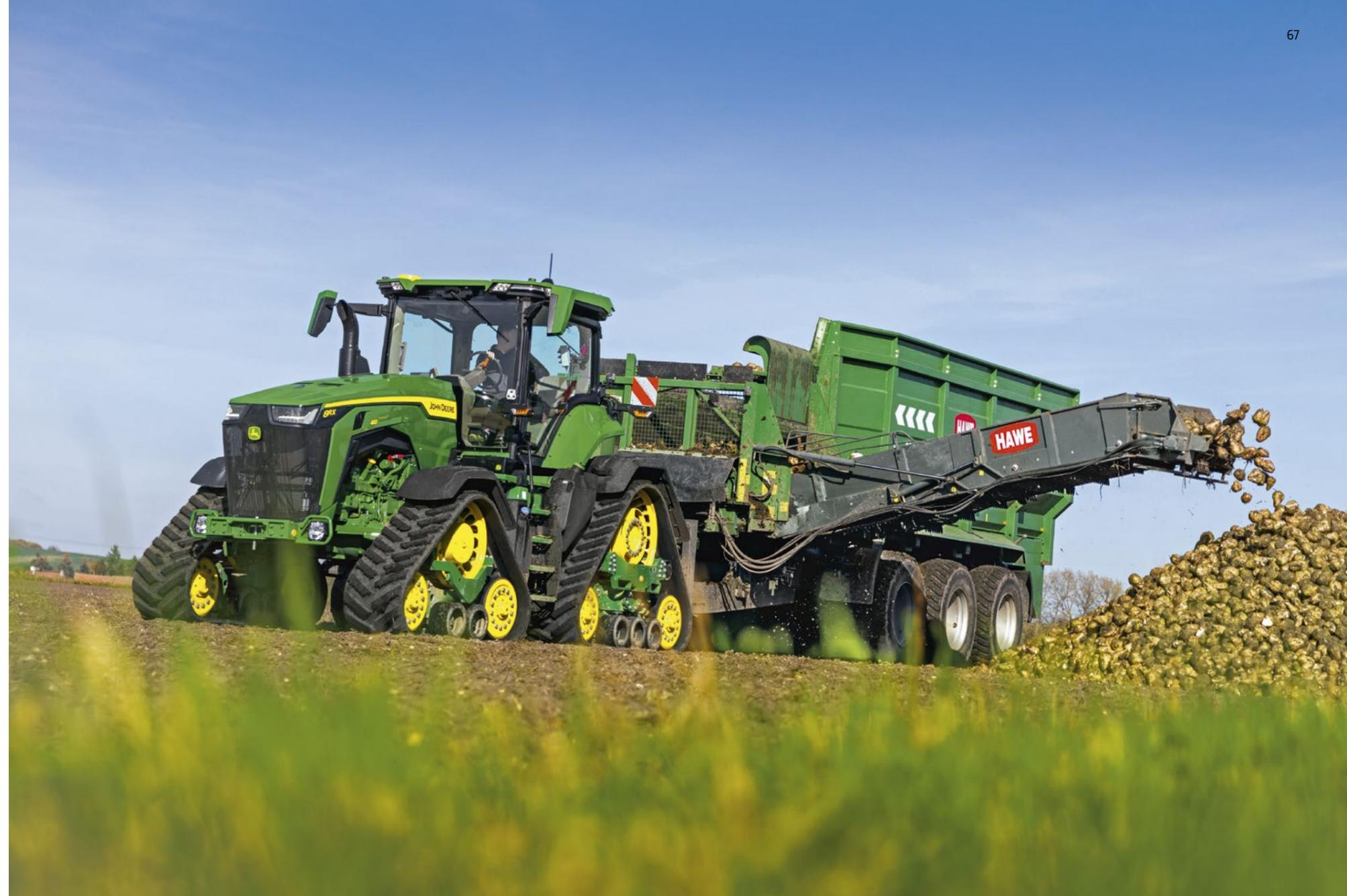
Eine Bodenkontaktfläche von 4,57 m<sup>2</sup> ist in dieser Leistungsklasse der Maßstab. Auch bei voller Ballastierung beträgt der statische Auflagedruck hinten nur 0,36 kg/cm<sup>2</sup>. Die Dammbildung am Vorgewende ist praktisch nicht vorhanden und der Wenderadius noch kleiner als beim Radtraktor der Serie 8.
