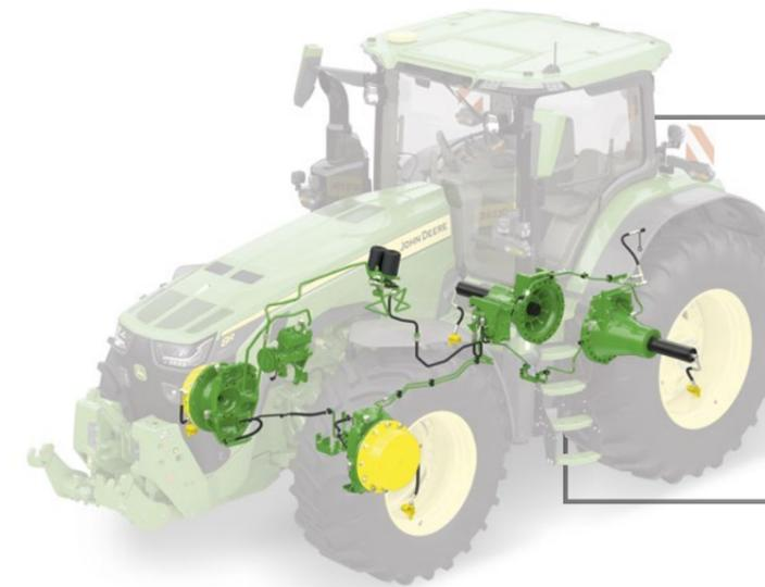
Die langlebigen Luftleitungen des zentralen John Deere Reifendruckregelsystems haben einen 33 % größeren Innendurchmesser als das integrierte System eines Wettbewerbers und ermöglichen dadurch schnellere Befüll- und Ablasszeiten. Dank der intelligenten Radventiltechnologie kann ein Einleitungssystem zum Einsatz kommen, bei dem die Luftleitungen nicht dauerhaft unter Druck stehen.
