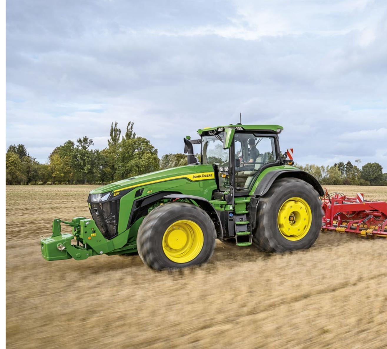
Spitzenleistung im Feld – Zehn Gänge im Hauptarbeitsbereich von 5 bis 16 km/h bieten den idealen Gang für die anspruchsvollsten Zugsanwendungen.
