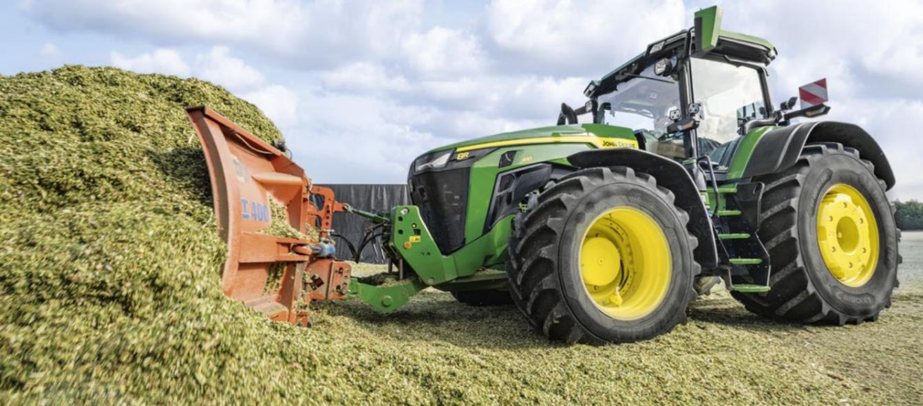
Der optional erhältliche, langlebige Frontkraftheber hat eine maximale Hubkraft von 5.200 kg an den Fanghaken und eignet sich perfekt für schwere Aufgaben mit Bodenbearbeitungsgeräten.
