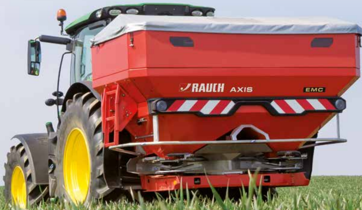
AXIS EMC - Drehmomentmessung mit Magnetostriktion-Sensoren (bekannt von E-Bikes und Segways)
