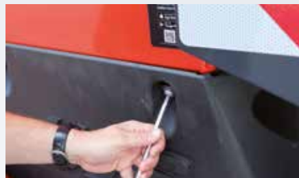
Schmutzfänger mit Schnellverschluss
