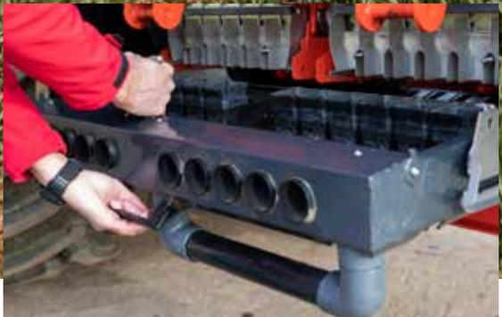
Einfaches Wegschwenken der Injektorkassette
