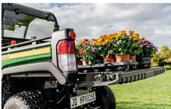
**Heckklappe der Deluxe-Ladepritsche:** Die verbesserte Ladeklappe ermöglicht bequemes Be- und Entladen, bietet lastwagenähnliche Eigenschaften und kann mit einer Hand bedient werden. Sie kann zur leichteren Reinigung oder zum Transport längerer Gegenstände geöffnet oder entfernt werden. Die standardmäßig eingebauten Befestigungsgurte lassen sich auch entfernen, sodass Sie die Heckklappe auf 150 Grad senken können.
