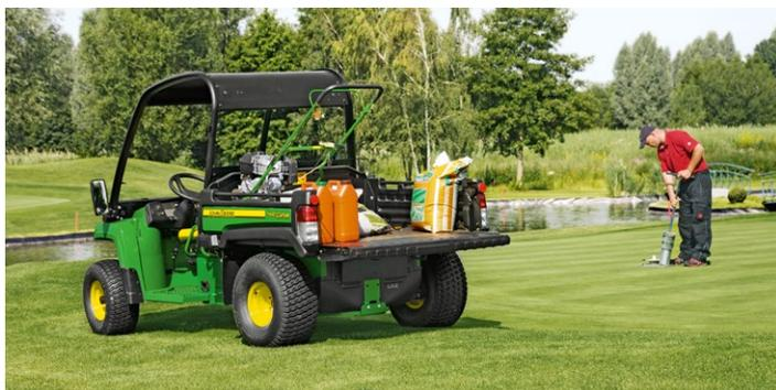
**Ausgesprochen hart im Nehmen:** Hinter seinem diskreten Auftreten verbergen sich solide, durchgehende geschmiedete Achsen, ein stabiles Hinterachsgehäuse aus Aluminium-Druckguss und eine modulierbare Ladepritsche. Damit nimmt es der Gator™ locker mit allen Aufgaben und Einsatzbedingungen auf.
