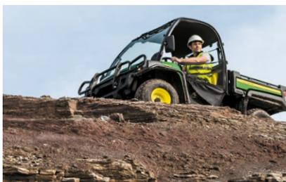
**Sicherheit geht vor:** Deshalb ist jedes Fahrzeug mit einem Überschlagschutz mit Sonnendach und komfortablen Dreipunktsicherheitsgurten ausgestattet, damit die Passagiere zu jeder Zeit sicher sind. Die hydraulischen Bremsen gewährleisten erstklassige Bremsleistung.
