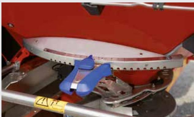
Die gut lesbare, mengenproportionale DfC-Skala, einzigartig von RAUCH, ermöglicht die zuverlässige Mengenkorrektur nach der Abdrehsprobe.
