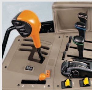
Bedienung ohne Joystick über die Hecksteuergeräte
