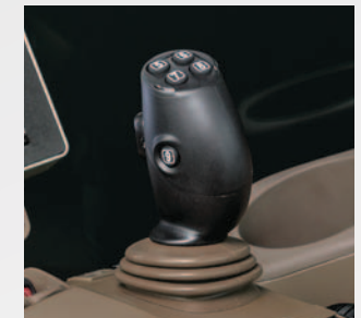
Elektronischer Joystick (E-ICV) im CommandARM integriert – für die Serien 6R, 7R und 8R
