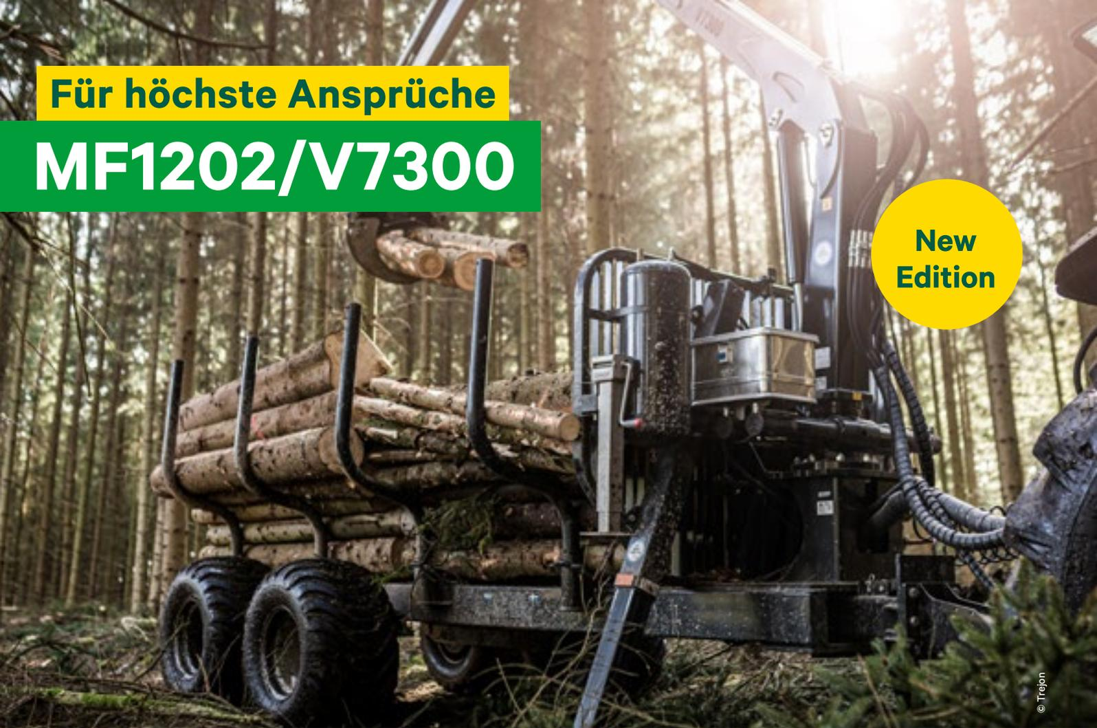
**Dieser neue Anhänger in unserem Programm bietet Ihnen gesteigerte Traglast durch das Doppelrahmenkonzept, Sie können mit 12.000kg Gesamtgewicht bei 25 km/h in der Grundausstattung und optional bei 40 km/h ohne Einschränkung des Gesamtgewichts auf öffentlichen Strassen Holz transportieren. Achsen und Bemskomponenten bieten in jeder Situation Reserven und sind von uns so konzipiert worden, dass Sie sich in schwierigen Situationen immer auf die Sicherheit Ihres Anhängers verlassen können.**
