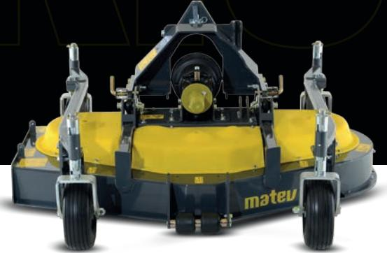
**MOW-FM 140 Frontmähwerk** | Das matev Mähwerk MOW-FM 140 mit Schnittbreite von 137 cm ist für den Frontanbau an Kompakttraktoren ab 23 PS entwickelt. Auch dank des geräuschreduzierenden PE-Covers ist dieses robuste Profi-Mähwerk besonders leise und vibrationsarm.
