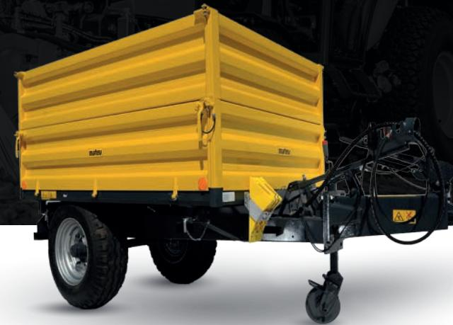
**TRL-3D 20 Einachs-Dreiseitenkipper** | Unser matev Trailer TRL-3D 20 mit einer Nutzlast von 2 Tonnen und einem Kippwinkel von 45° eignet sich optimal zum professionellen kommunalen Einsatz oder zur Nutzung im Garten- und Landschaftsbau.
