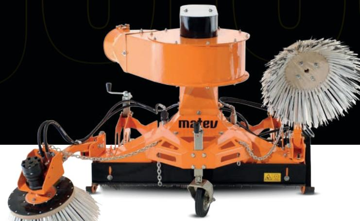
**MRM-120 AS Saug-Kehrsystem** | Das Saug-Kehrsystem MRM-120 AS ist ein perfektes Werkzeug für die Profi-Flächenpflege. Dank der aktiven Absaugung und diversen Austattungsmöglichkeiten kann es problemlos Laub, Grünschnitt, Schmutz oder Müll entfernen.
