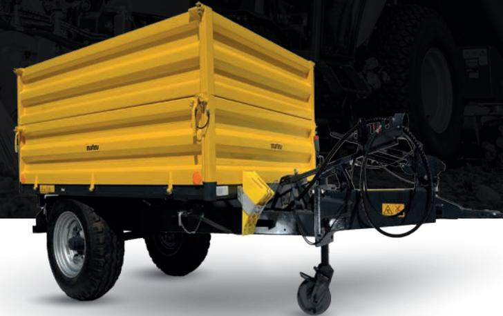
**TRL-3D 20 Einachs-Dreiseitenkipper** | Unser matev Trailer TRL-3D 20 mit einer Nutzlast von 2 Tonnen und einem Kippwinkel von 45° eignet sich optimal zum professionellen kommunalen Einsatz oder zur Nutzung im Garten- und Landschaftsbau.
