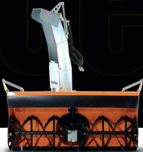
**SBL-40 Schneefräse** | Unsere robuste und kraftvolle Schneefräse SBL-40 mit 400 mm Fräswalze ist für den Anbau an Kompakttraktoren mit 12-30 kW konzipiert und eignet sich ideal für Schneehöhen von bis zu 650 mm.
