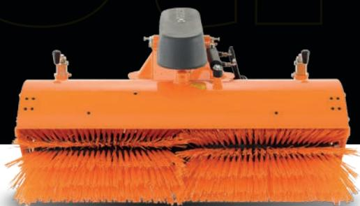
**SWE-45 Kehrmaschine** | Die robuste Frontkehrmaschine mit 450 mm Kehrwalzendurchmesser und Mittelantrieb ist ideal für den professionellen Einsatz zum Schmutz- und Schneekehren an Klein- und Kommunaltraktoren und Trägerfahrzeugen zwischen 13 und 36 kW.
