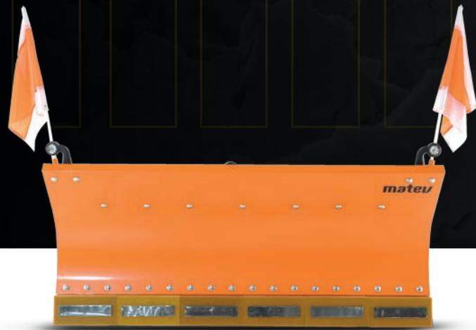
**SRM-SF Schneeräumschild** | Dieses stabile Federklappenschild in Segmentbauweise mit einer Schildhöhe von 61 bzw. 75 mm, serienmäßigem Pendelausgleich und hydraulischer Winkelverstellung, ist optimal für den Profi-Einsatz an Kompakttraktoren 17 bis 42 kW abgestimmt.
