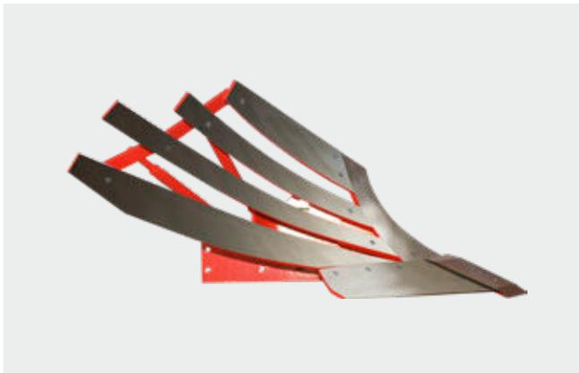
Pflugkörper mit einer speziellen Aufkohlung überzeugen durch eine superharte Außenschicht von 2,3 mm auf beiden Körperseiten sowie einen elastischeren Kern. Diese Kombination gewährleistet optimale Bearbeitung von Böden mit schlechtem Fließverhalten und wechselnder Struktur.
