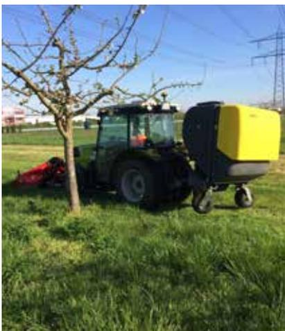
Große Gehäuseüberhänge, Deflektoren und Gummischürzen am GA40 verhindern das Herausschleudern von Gegenständen – und sorgen für mehr Sicherheit bei den Mulcharbeiten.
