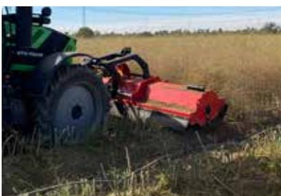
**GS56V – mit hydraulischer Seitenverschiebung
