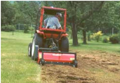
Der Vertikutierer ST40 entfernt Filzschichten, die sich aus abgestorbenen Pflanzenteilen bildet. Zusätzlich werden die in die Breite wachsenden Wurzeln zertrennt, so dass neue Graspflanzen wachsen können.
