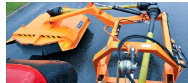
Die Maschine wird mit einer Gelenkwelle von Walterscheid geliefert, die für die Heckmontage geeignet ist. Optimaler Überblick über die gesamte Maschine.
