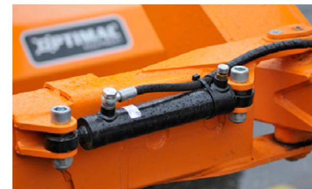
Ein Arm des integrierten Seitenverschwenkungsrahmens ist teleskopisch und mit einem hydraulischen Kollisionsschutz ausgerüstet, der mit dem Hubzylinder verbunden ist. Beim Auffahren auf ein Hindernis wird der Mulcherkopf gleichzeitig nach hinten und oben bewegt und kehrt anschließend wieder in den Betriebsmodus zurück.
