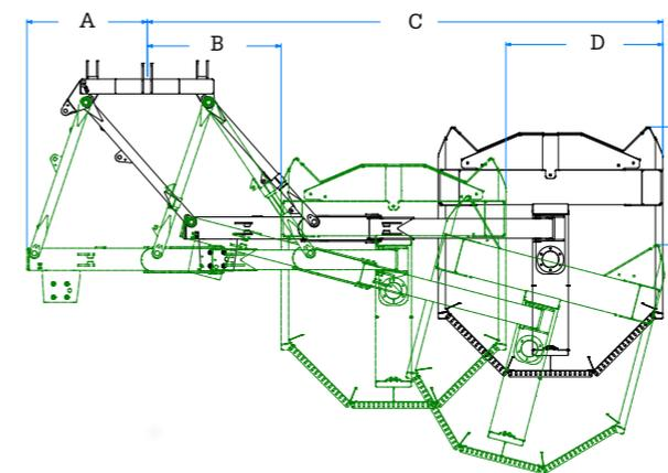
Hydraulischer Kollisionsschutz, wird beim Auffahren auf ein Hindernis auf 96 cm zurückbewegt.
