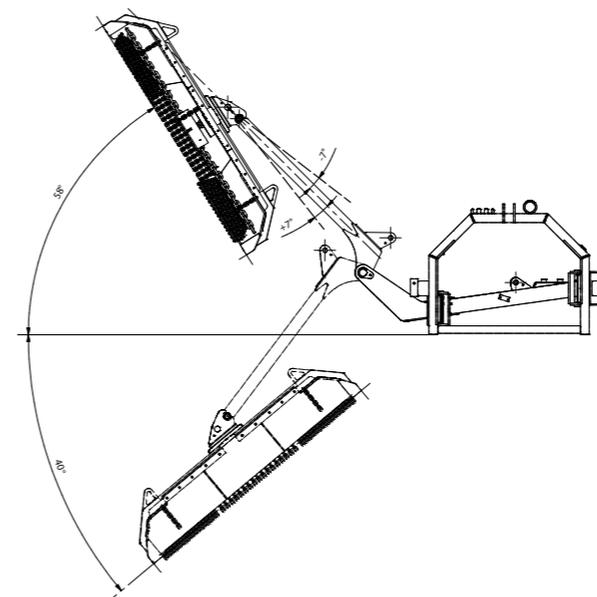
Arbeitsbereich mit der Gelenkwelle in Standardausführung. Optional wird eine Gelenkwelle mit Weitwinkelgelenk angeboten, die den Arbeitsbereich vergrößert.
