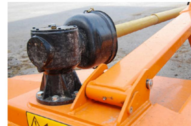
Robustes, überdimensioniertes Getriebe. Die Befestigung des Kettenkopfes ist schwenkbar.
