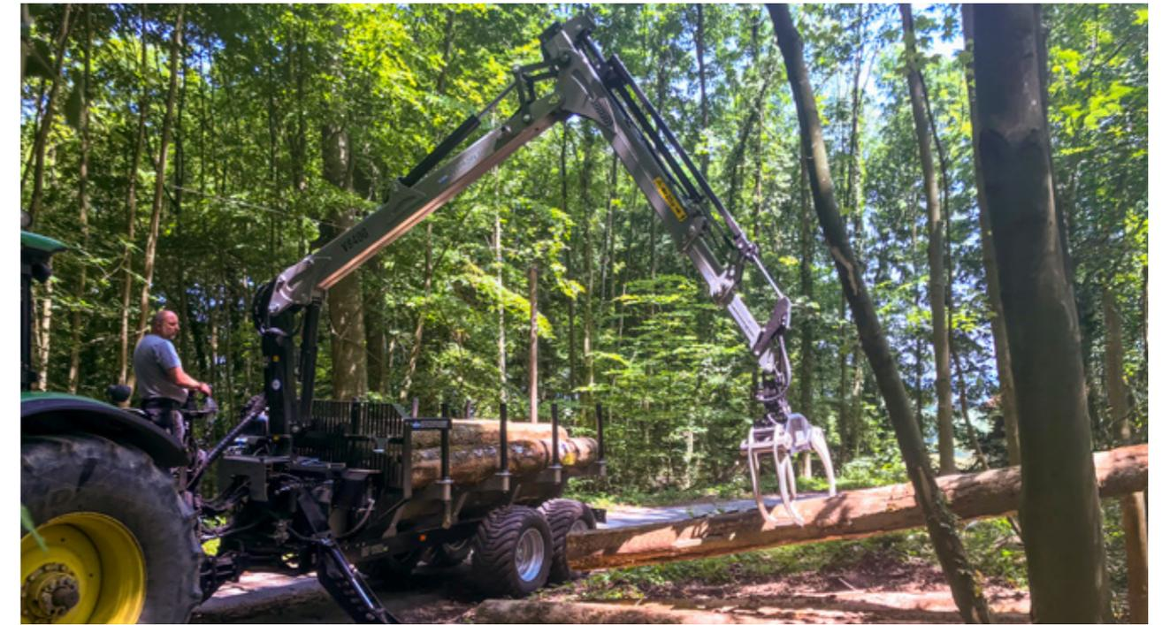
Die Forwarderrungen sind flexibel positionierbar. Der Laderaum hat eine Länge von 4,15m, mit optionaler, ausziehbarer Rahmenverlängerung sind es 5,15 m.
