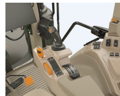
Kompakter CommandARM™ mit Bump Shifter oder Linearhebel, A-Säulendisplay und optionalem G5/G5 Plus -Universaldisplay
