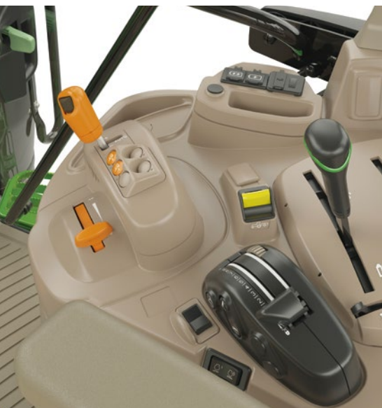
Rechte Konsole mit elektrischen oder mechanischen Zusatzsteuergeräten (ZSG) und A-Säulendisplay
